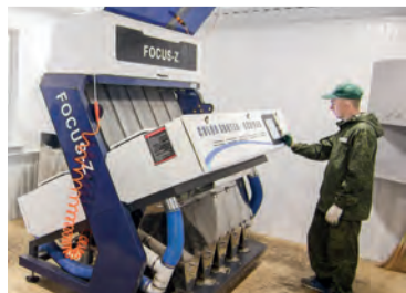
Финальная стадия очистки семян производится с использованием трех оптических сортировщиков, которые позволяют получать чистоту посевного материала 99,9%.
