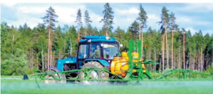
Система дифференцированного внесения удобрений онлайн (RT 200, N-Sensor). Бортовой компьютер в реальном времени определяет потребность в питательных веществах и управляет разбрасывателем.
