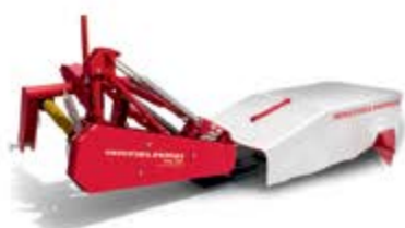
Косилки ротационные навесные STRIGE 2100/2400/2800/3200 ширина захвата от 2,1 до 3,2 м производительность от 3 до 4,8 га/ч
