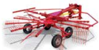
Грабли роторные навесные KOLIBRI 471 ширина захвата 4,7 м производительность 5,6 га/ч
