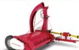
Прицепной кормоуборочный комбайн STERH 2000 производительность 38 т/ч, рабочая скорость до 7,2 км/ч
