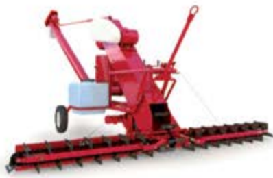
Протравливатель семян самопередвижной ПСМ-25 электрический привод производительность до 20 т/ч
