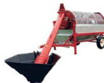
Зерноочиститель ОЗМ-20 диаметр барабана 122 см производительность до 20 т/ч
