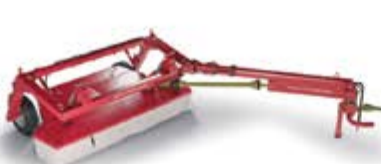
Косилка прицепная BERKUT 3200 ширина захвата 3,2 м производительность 4,5 га/ч
