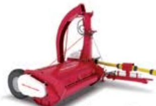
Прицепной кормоуборочный комбайн STERN 2000 производительность 38 т/ч рабочая скорость до 7,2 км/ч
